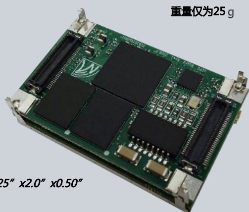
世上最小的以太网/串口/ USB网关
