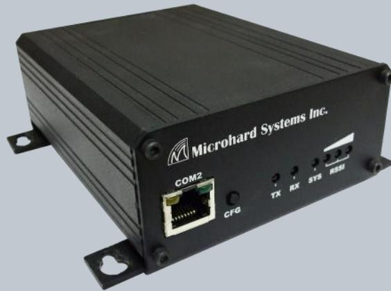
为用于工业以太网和串行设备集成到IP/以太网网络提供了完整的无线解决方案。IP921允许以太网设备共享高速无线媒体，并提供无线网关为网络应用程序来访问串口设备。IP921还具有灵活的维护实用程序和网络管理工具。
